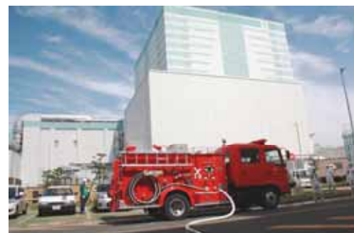
消防車による原子炉建屋への送水（1号機）
